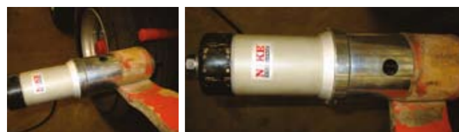
Demontage einer Buchse mit dem 18 t EBH-Auspresswerkzeug
